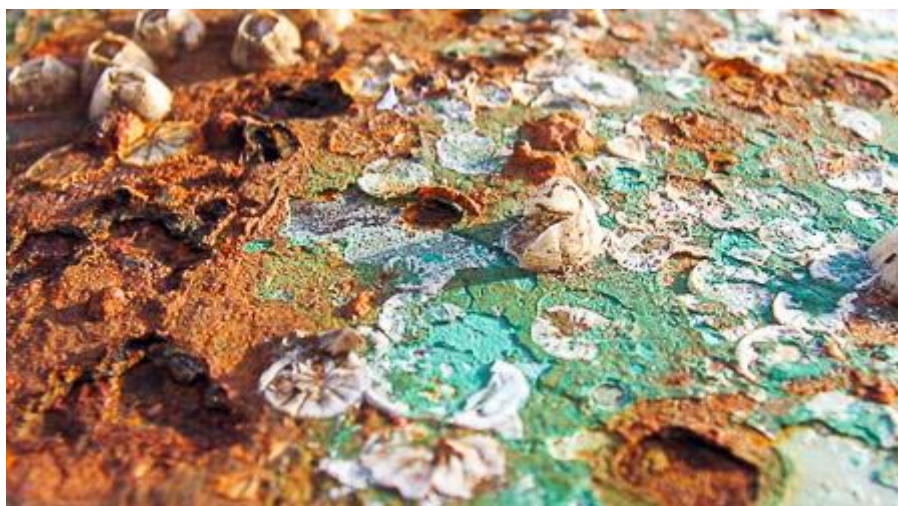
Fot. 2. Biokorozja metalu powodowana przez mikroorganizmy
