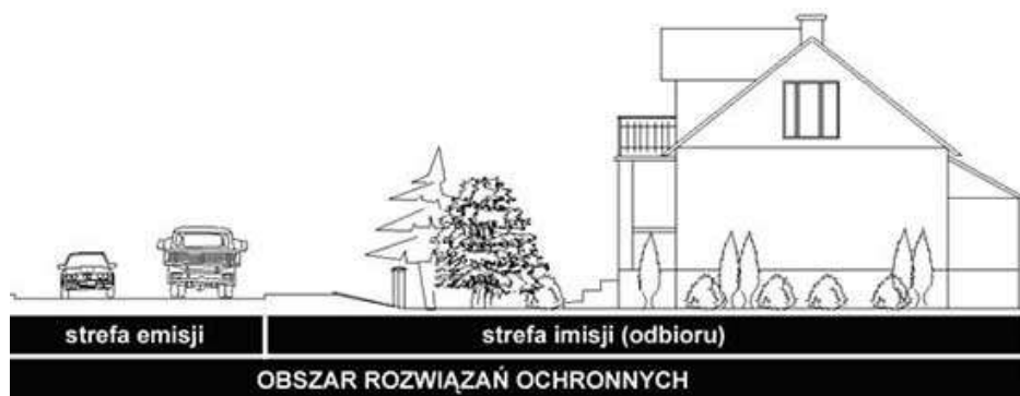
Rys. 9. Strefy emisji i imisji hałasu oraz obszar rozwiązań ochronnych w uniwersalnym podejściu do ochrony przed hałasem drogowym
