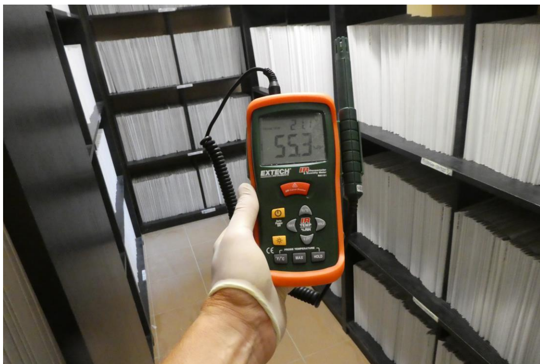
Fot. Pomiar wilgotności względnej i temperatury powietrza w pom. 16 archiwum Wydział Komunikacji (55,3%, 21,1°C)
