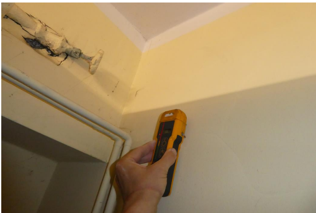
Fot. Czerwona świecąca dioda wilgotnościomierza wskazuje na wysoki poziom zawilgocenia ściany zewn. na wysokości ponad 2 m. Pomieszczenie archiwum nr 13 Wydział Komunikacji
