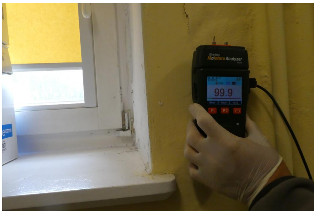
Fot. Pomiar wilgotności ściany przy oknie archiwum pom. nr 020
