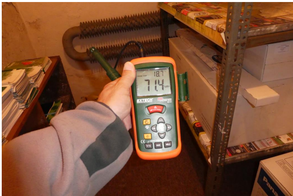
Fot. Pomiar wilgotności względnej i temperatury powietrza w pom. 001 (71,4%, 18,7°C)
