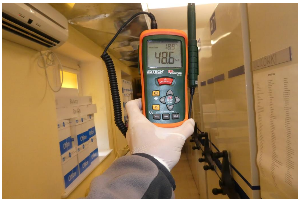
Fot. Pomiar wilgotności względnej i temperatury powietrza w pom. 020 archiwum (48,6%, 18,9°C)
