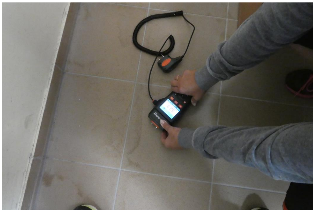
Fot. Badanie poziomu wilgotności względnej posadzki w pom. 16 Wydział Komunikacji: 52,3%
