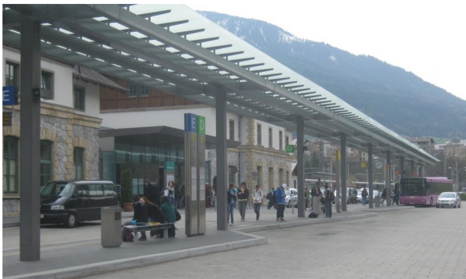
Rys. 12.3.1. Perony autobusowe przed dworcem kolejowym w miejscowości Landeck (Austria). Zaprojektowanie peronów w taki sposób ułatwia ich opuszczenie przez autobus. źródło: materiały własne TRAKO.
